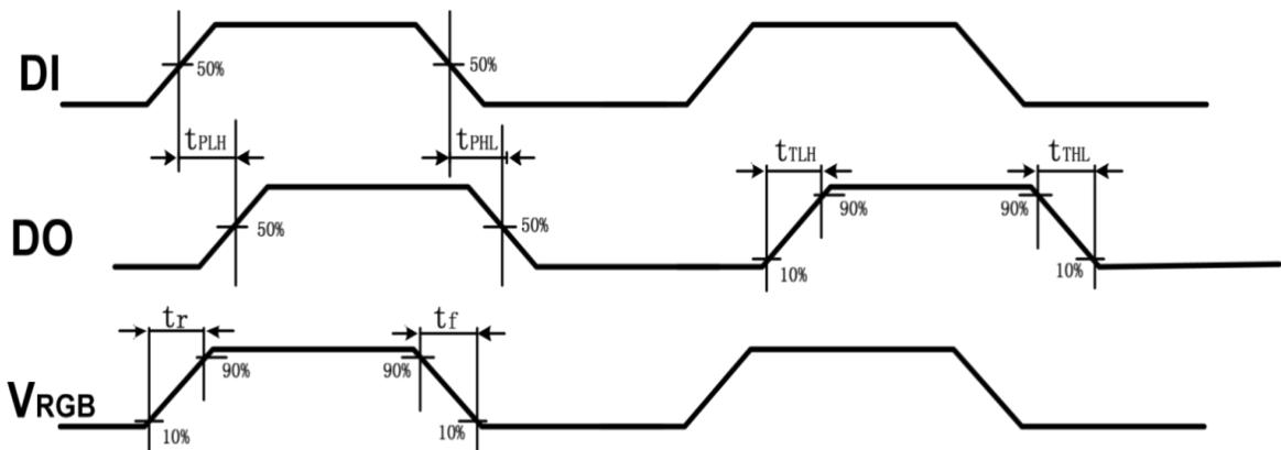
时序波形图 : Time sequence oscilloscope
