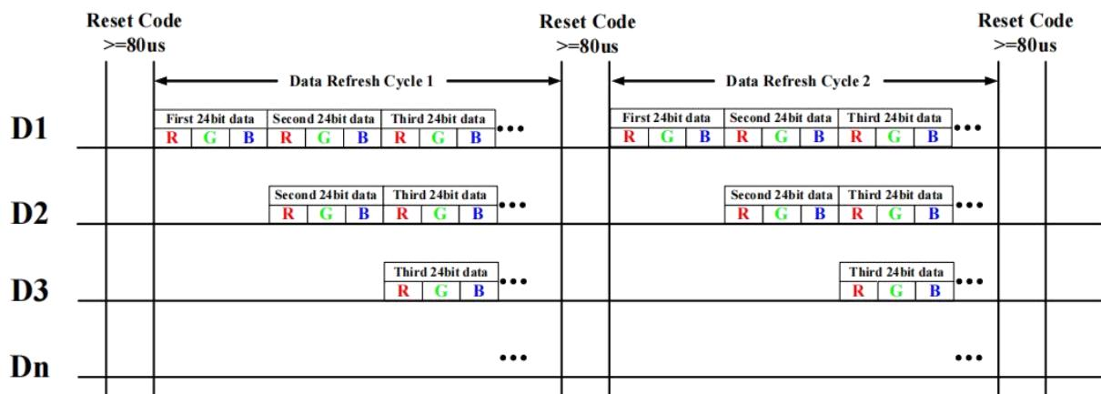
注: 其中 D1 为 MCU 端发送的数据, D2、D3、D4 为级联电路自动整形转发的数据。
